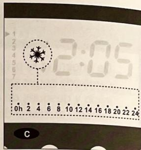
**d** Si se desea cambiar esta programación, pulsar la tecla + para modo ☀, la tecla - para modo ☾ y la tecla Ⓛ para modo ☀. La pulsación mantenida avanza/retrocede rápidamente. La programación se hace de hora en hora y se visualiza perfectamente la hora seleccionada porque ésta parpadea.
