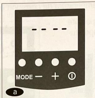
**b** Pulsar el botón tecla marcha/paro . El Eco-Emisor se enciende, apareciendo en la pantalla el símbolo del Modo de Funcionamiento (el último seleccionado o el Modo Confort después de una desconexión prolongada de la red eléctrica) y la temperatura ambiente medida o temperatura seleccionada.
